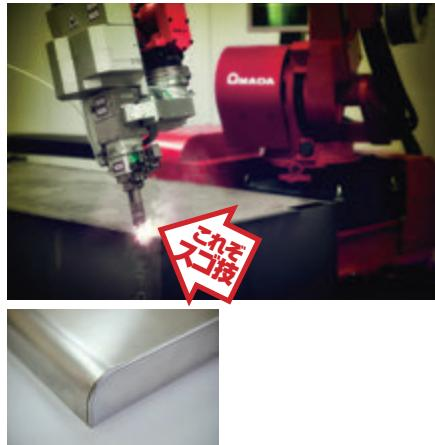
エネルギー効率が高く、高出力が可能、ビーム品質に優れ安定性が高いことなどからレーザー加工の主流となっているファイバーレーザー溶接技術。
