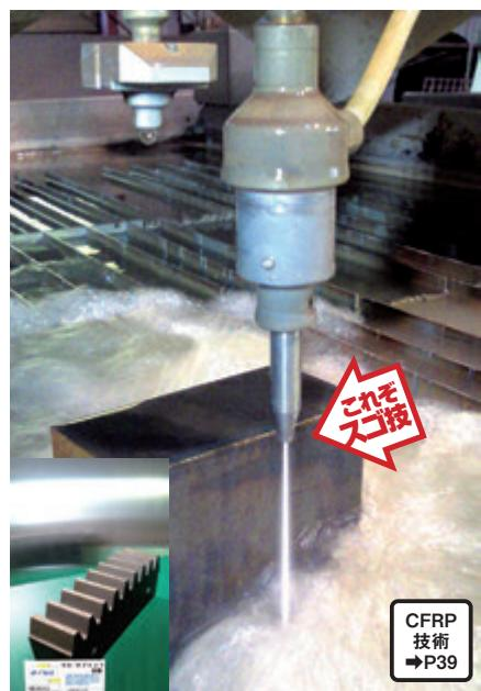
ウォーター切断は高圧の水で素材を切るために、アルミニウム、チタン、木、ステンレス、ゴム、セラミックのほか、複合材や張り合わせ材といった硬質軟質の複合多素材の切断ができる。複雑な形状の切断が可能であるだけではなく、切断時の熱影響がほとんどないので、素材の変色や硬化など素材の変質を最小限に抑えられる。
