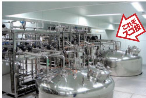
主に製薬関係の注射用水設備、調製設備を取り扱っている。
