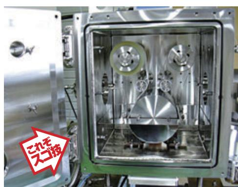
ロールツーロールでプラスチックフィルム基板に金属薄膜を高速で形成できる、コンパクトでエコノミーなスパッタリング装置を試作開発。これにより、フィルム走行系に工夫をすることで、PET等の耐熱性の低いフィルムにも高速成膜できる可能性を見出した。
