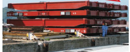
**コンテナ船用のハッチカバー**では、**日本一の生産量**を誇るイワキテック。ポンツーンタイプ、ローリングタイプ、フォールディングタイプの3種類の自社ブランドの中でも、ポンツーンタイプ(コンテナ船用)は、生産量・質ともに高い評価を得ている。
