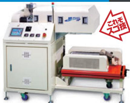
メルトプローフ法とは、溶融した熱可塑性プラスチック樹脂を多数のノズル孔から吐出させ、高速の熱風により極細纖維化し、ネットコンベー上に吹き付けることでシート状にする不織布製造方法。
