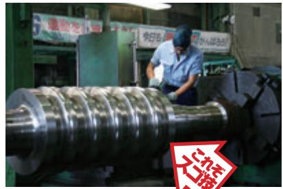
製鋼所で使われる圧延ロールの機械加工を中心に、重量物、長尺物の加工を行なう。
