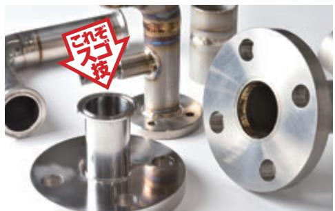
腐食や錆に非常に強く、食品や医薬品、半導体製造工場の配管などに使われるチタン、ハステロイ、ジルコニウムなどの特殊材の溶接技術を有する。溶接部分の酸化を防ぐ特殊な溶接治具を独自に開発し、丈夫で高品質な溶接加工が可能。
