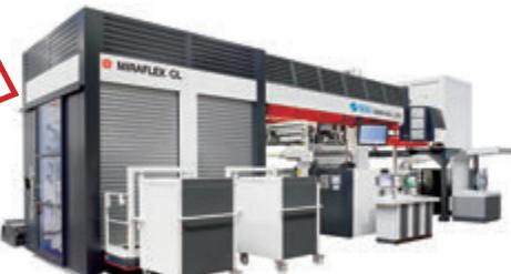
同社の軟包材への水性フレキソ印刷・加工は、インキ成分に有機溶剤(VOC)をほとんど含まず、インキの塗布量もグラビア印刷の半分以下。VOCを発生させないため燃焼処理が不要でCO2の排出を大幅に削減できる。
