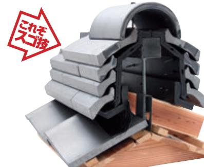
阪神・淡路大震災をきっかけに、日本建築における瓦屋根の耐震工法に取り組んできた同社が独自に開発した「耐震箱棟eeBOX」。従来の棟に使用していた土や漆喰を排除し、木製もしくは樹脂製のBOXに瓦を直接ビス打ちして固定することで強度と耐久性を確立。
