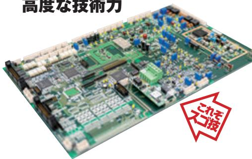
サイクロotron用電磁石電源や、超電導電磁石電源などの様々な特殊電源に組み込む制御装置の開発・製造を行っているテクノマジック。
