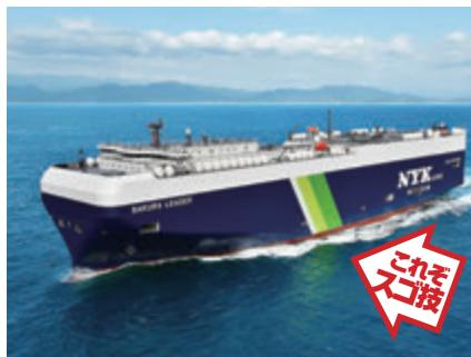
世界の自動車運搬船の建造において、約22%のシェアを占め世界トップクラスの実績を誇る。2020年には**国内造船所で初となる大型LNG燃料自動車運搬船**を建造し、独自開発の省エネ付加物を装備することで、CO2排出量を40%以上削減(2008年比)した。
