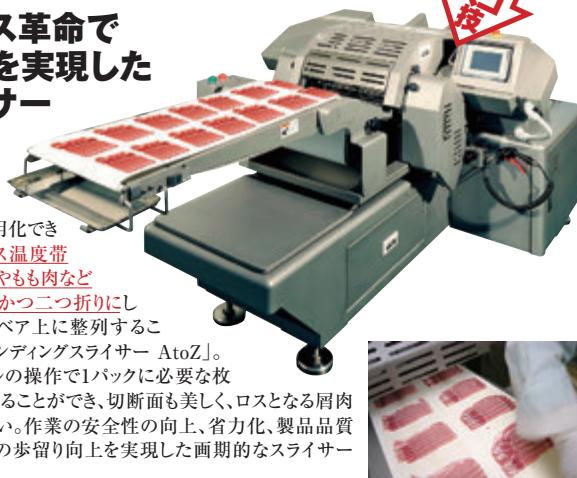
これまで実用化できなかったプラス温度帯の豚ロース肉やもも肉などを薄切りに、かつ二つ折りにした状態でコンベア上に整列することができる「ベンディングスライサー AtoZ」。タッチパネルの操作で1パックに必要な枚数だけ並べることができ、切断面も美しく、ロスとなる肩肉の発生も少ない。作業の安全性の向上、省力化、製品品質の向上、材料の歩留り向上を実現した画期的なスライサーである。
