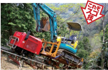
モノレールの設置には地形の制約が少ないので、電力、通信、土木、農業、林業など、傾斜地での運搬の効率化・省力化に最適。
