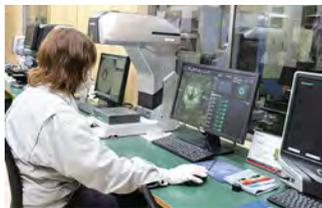
画像寸法測定器、高さ平面度測定器等導入
