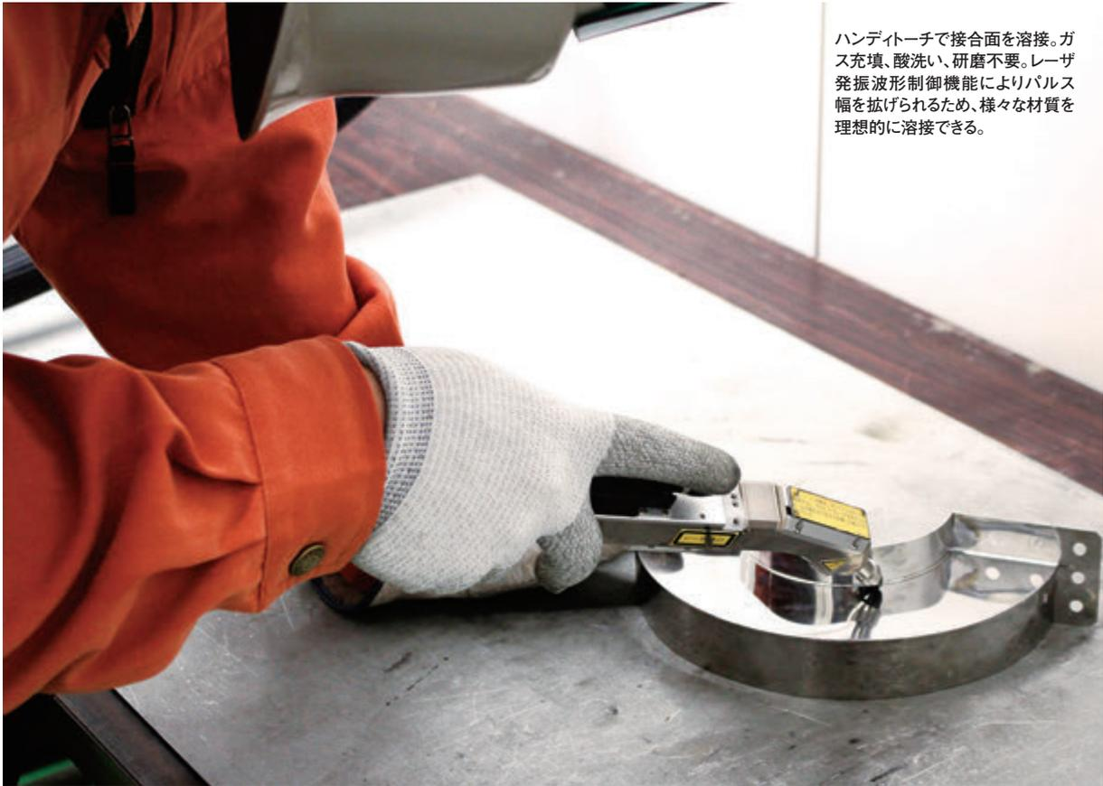
ハンディタイプで接合面を溶接。ガス充填、酸洗い、研磨不要。レーザー発振波制御機能によりパルス幅を広げられるため、様々な材質を理想的に溶接できる。
