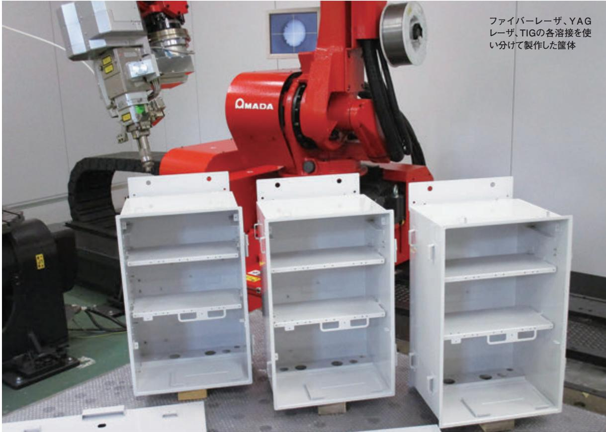
ファイバーレーザ、YAGレーザ、TIGの各溶接を使い分けて製作した筐体
