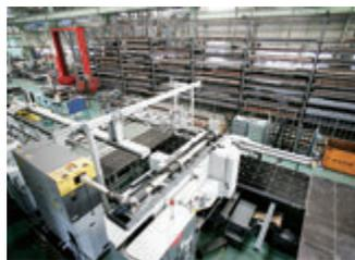
住友重機械工業(株)の工場内での製缶塗装請負業務からスタートした(株)西岡鉄工所。現在の広大な自社工場では、板金自動加工システム、粉体塗装対応の焼付塗装設備、2016年に導入した板材・形鋼兼用レーザ加工機など多様な設備を保有。
