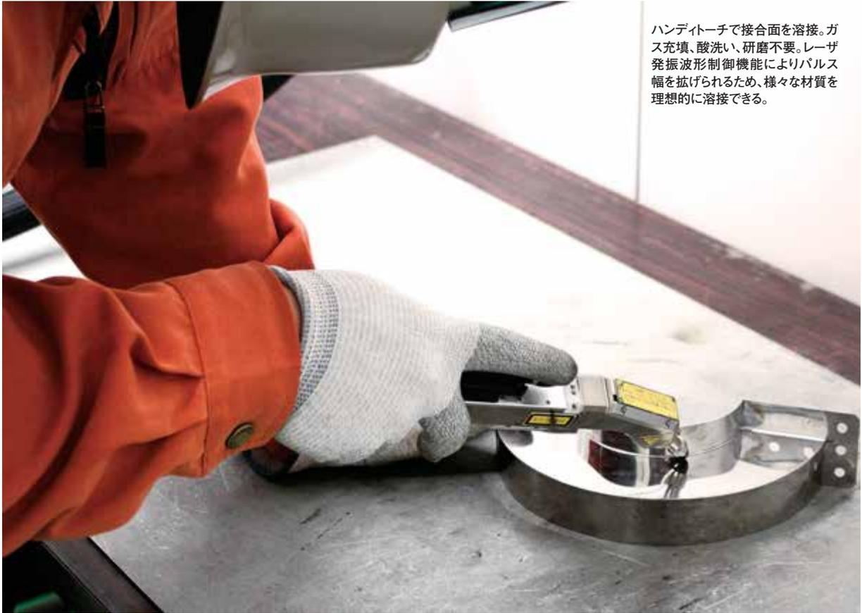
ハンディタイプで接合面を溶接。ガス充填、酸洗い、研磨不要。レーザー発振波形制御機能によりパルス幅を広げられるため、様々な材質を理想的に溶接できる。
