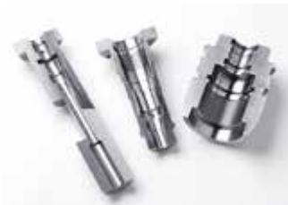
高度な技術を駆使した複雑で繊細な内径加工を最も得意とする長曽鉄工所。直径の小さな部品加工は削り屑が詰まりやすいため加工がしにくく、効率も悪いとあって苦手とする同業他社も多いなか、他では真似のできない卓越した技術力により高精度・高品質の製品を世に送り出している。
