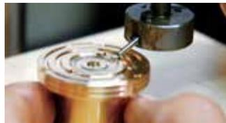
油圧機器の精密部品が主力商品のため、製品にはシビアな精度が求められる。クリアランス精度5ミクロンを可能にする技能を有し、最も高度な精密部品は公差が±1ミクロン以内を実現している。
