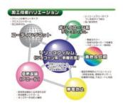
電子材料・光学分野にも適合する広幅クリーンコーターを保有しており、2,250mm広幅加工対応、かつハイクリーン(ヘッド部: クラス100)な機能フィルムの提案が可能です。成形用離型フィルムは、樹脂成型時に金型と樹脂の間にフィルムを入れることで金型が汚れずに生産性向上が見込まれます。また、電子部品の離型フィルムには、シロキサンによる回路不良を防ぐ非Si系の離型フィルムをご提案するなど、蓄積された技術力とノウハウで、幅広いニーズに対応致します。
