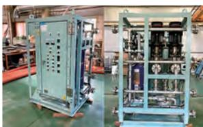
バラスト水処理用薬剤冷却、MGO冷却、排気ガス還元処理用尿素水冷却、電気推進船バッテリー冷却、電力変換器冷却など、各種装置及び制御システムを構築し多数の船舶に納入。それぞれの使用環境や用途、運用要件を総合的に満たす最適な設計・製造・施工を行っている。
