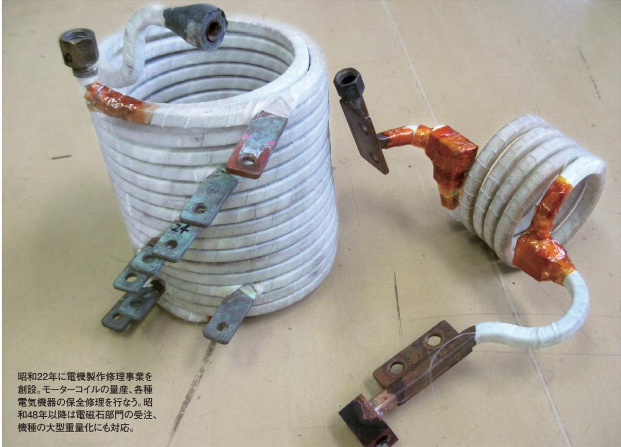
昭和22年に電機製作修理事業を創設。モーターコイルの量産、各種電気機器の保全修理を行なう。昭和48年以降は電磁石部門の受注、機種的大型重量化にも対応。
