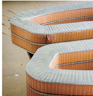
銅管を様々な形に整形しながら巻線する電磁コイルの製作から通電試験、組立塗装まで一貫体制を確立。リフティングマグネット、ブレーキマグネット、各種産業用電磁コイル製作及び修理を主に扱う。
