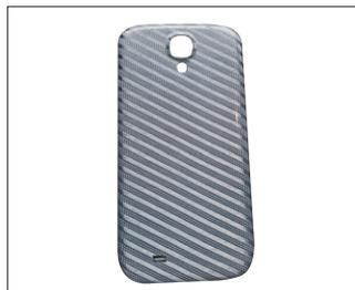
熱可塑性プリプレグには母材樹脂が重合 (高分子化) 済みのものと、より加工性が優れた半重合状態のもの2種類があり、半重合のプリプレグは常温下でも安定した状態を保つことのできるという、これまでの熱可塑性FRPにはない性質を持った素材であり、従来の熱硬化性FRPより加工しやすいという特徴を持っている。取り扱いが容易であることから加工にかかるコストの削減が可能。炭素、ガラスのほかにもさまざまな繊維を使った熱可塑性プリプレグがある。
