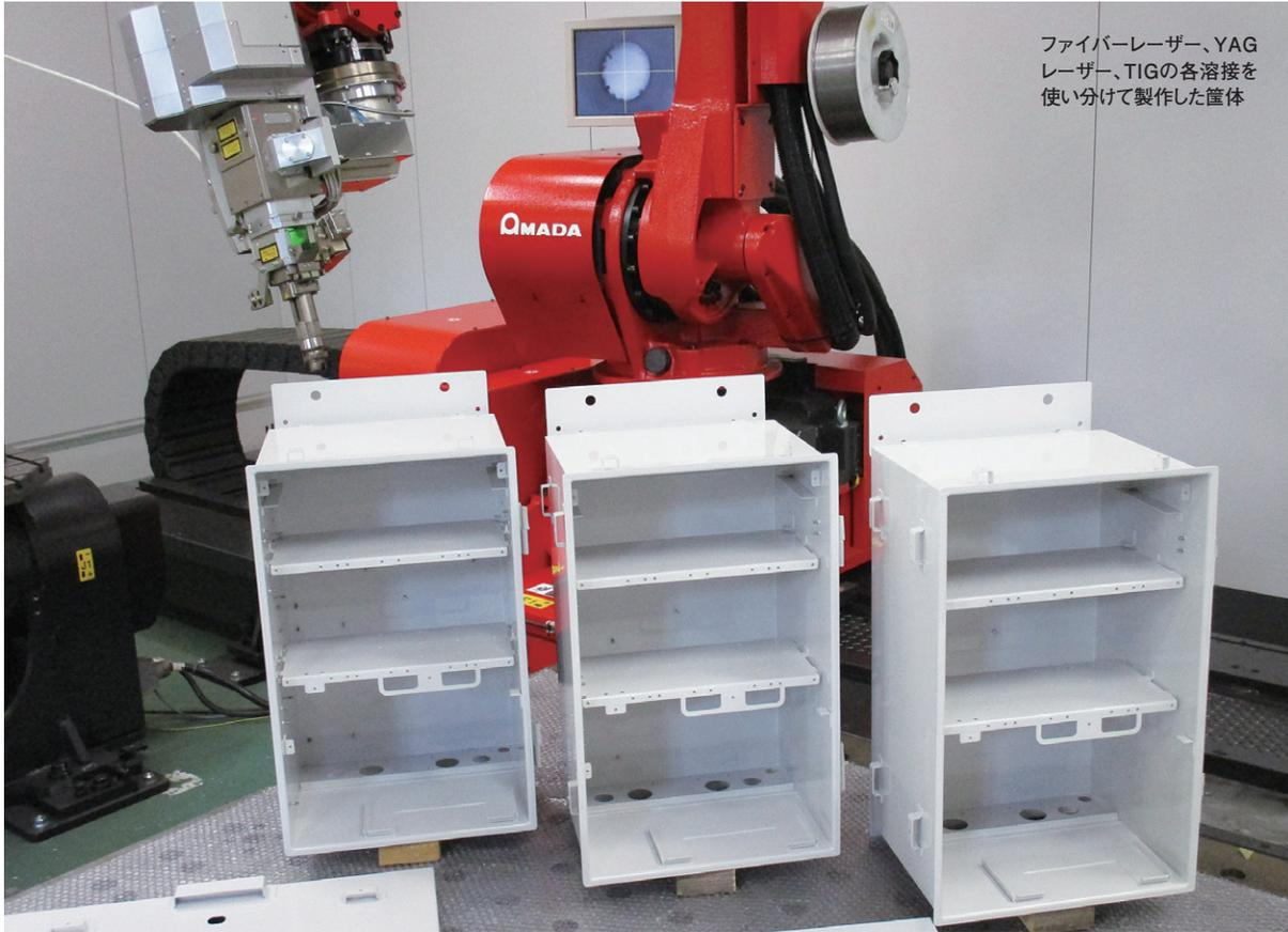
ファイバーレーザー、YAGレーザー、TIGの各溶接を使い分けて製作した筐体
