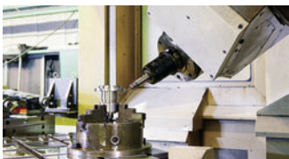
人口衛星の部品を製造した多面加工機
