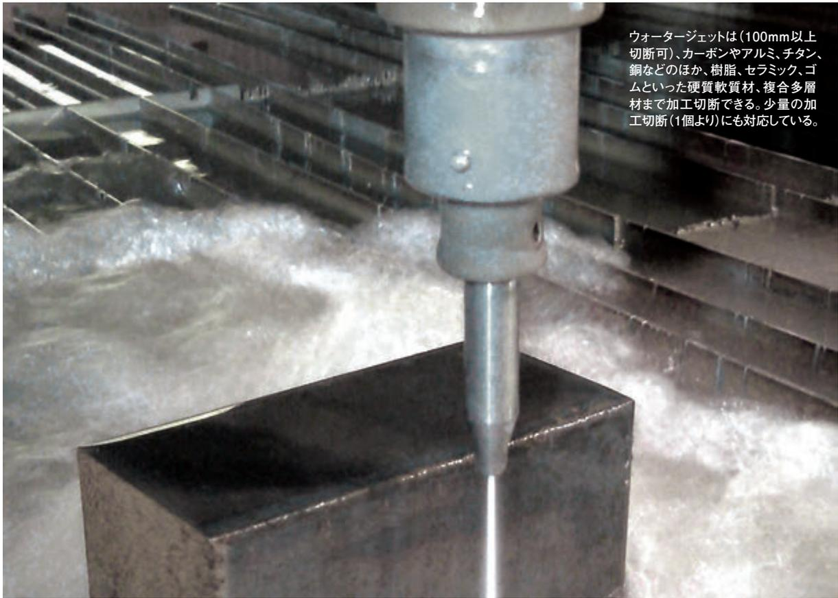
ウォータージェットは(100mm以上切断可)、カーボンやアルミ、チタン、銅などのほか、樹脂、セラミック、ゴムといった硬質軟質材、複合多層材まで加工切断できる。少量の加工切断(1個より)にも対応している。
