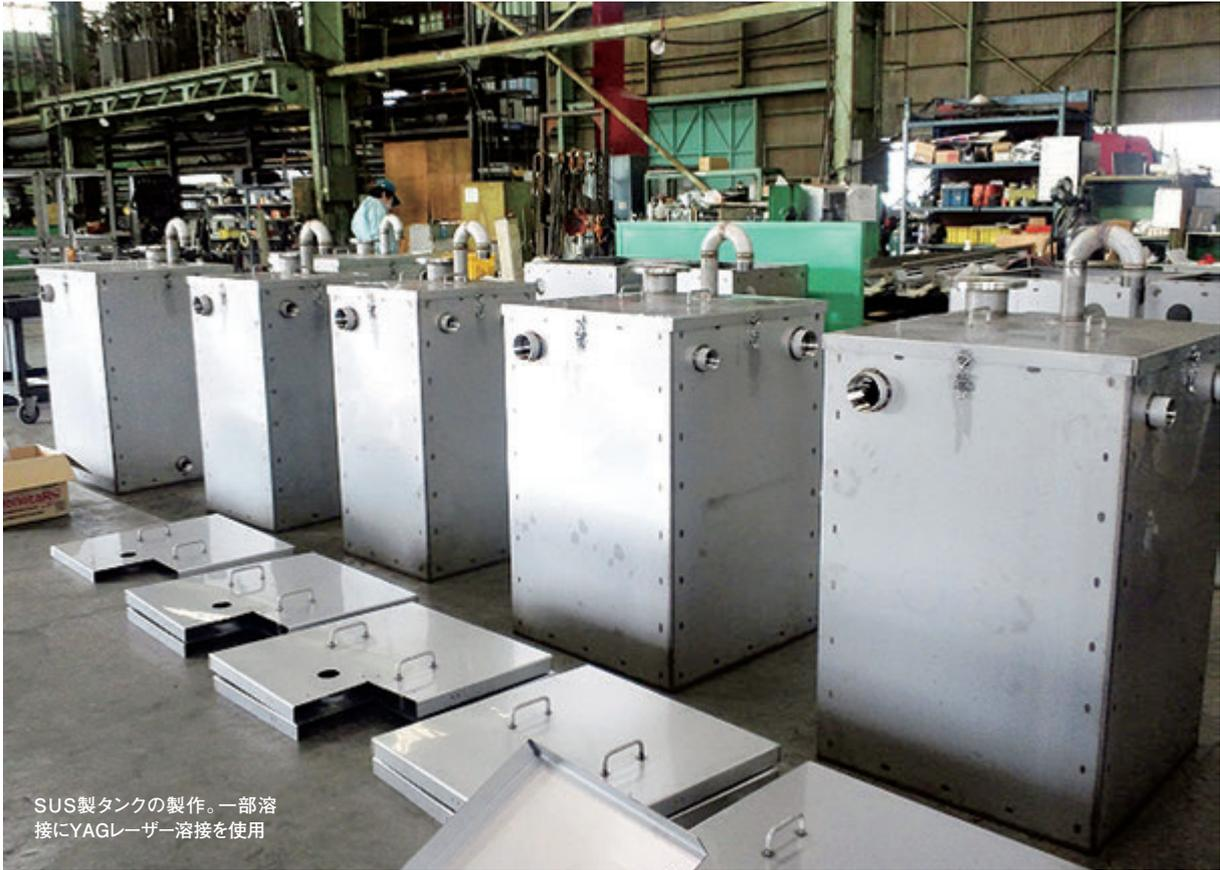
SUS製タンクの製作。一部溶接にYAGレーザー溶接を使用
