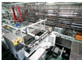
住友重機械工業(株)の工場内での製缶塗装請負業務からスタートした(株)西岡鉄工所。現在の広大な自社工場では、溶剤塗装に加え、粉体塗装にも対応できる全長8mの「大型乾燥炉」や、自動搬送システムと連動した板金自動加工システムをつくり上げた。
