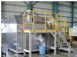
平成18年から施行された「大気汚染防止法の一部を改正する法律」の対象である塗料、接着剤、インキなどに溶剤として含まれる揮発性有機化合物を、800度以上の高温で酸化分解させることにより99%以上の分解効率を実現させた。
