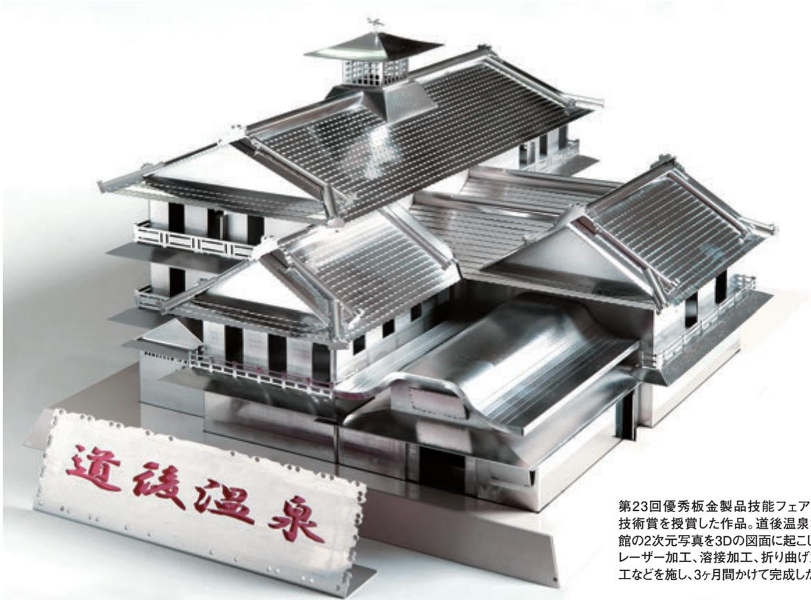
第23回優秀板金製品技能フェアで技術賞を授賞した作品。道後温泉本館の2次元写真を3Dの図面に起こし、レーザー加工、溶接加工、折り曲げ加工などを施し、3ヶ月間かけて完成した。
